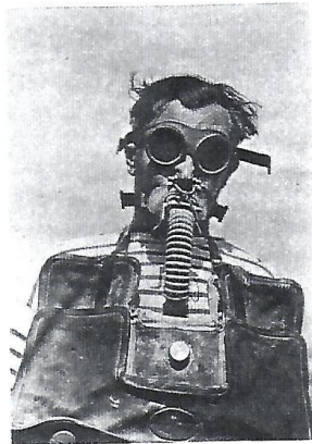
Le poumon Davis est en service à bord de tous nos sous-marins. Mais son emploi demeure délicat par grande profondeur.
