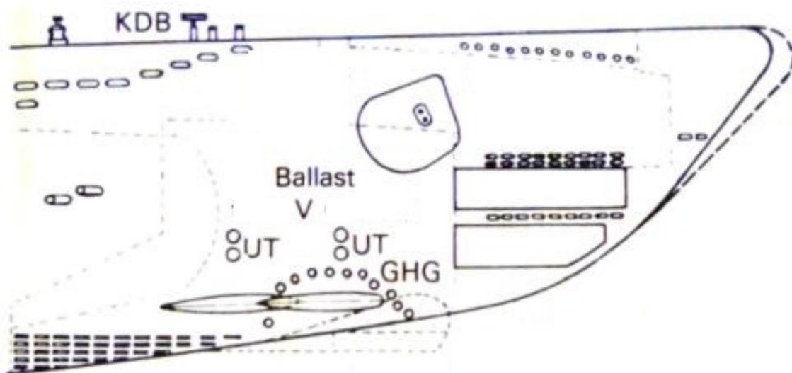
KDB (Kristall-Basisgerät) : Dispositif à cristaux sur base rotative.
